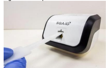
Fig. 5 Inserir a pá de limpeza para baixo e para cima
