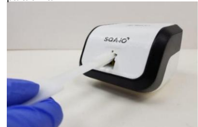
Fig. 6 Secar a câmara de teste com esponja
